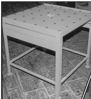
Mesas con bolas transportadoras de equipos pesados (seguridad)
