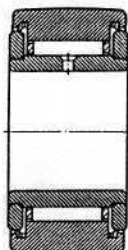
Serie NATR .. PP con obturaciones y superficie de rodadura bombeada
