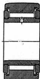
Serie NATV .. PP lleno de agujas con obturaciones y superficie de rodadura bombeada
